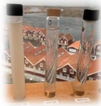
Processvatten i olika reningssteg
