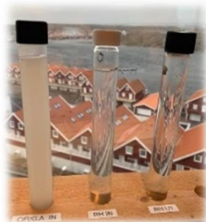
Processvatten i olika reningssteg
