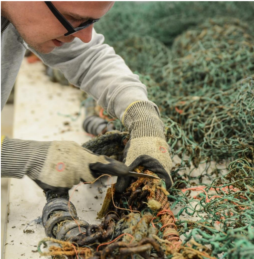
Manuell demontering och sortering av en uttjänt trål. Delar av bly, stålvarer, kätting samt olika plasttyper kan urskiljas på bilden.
